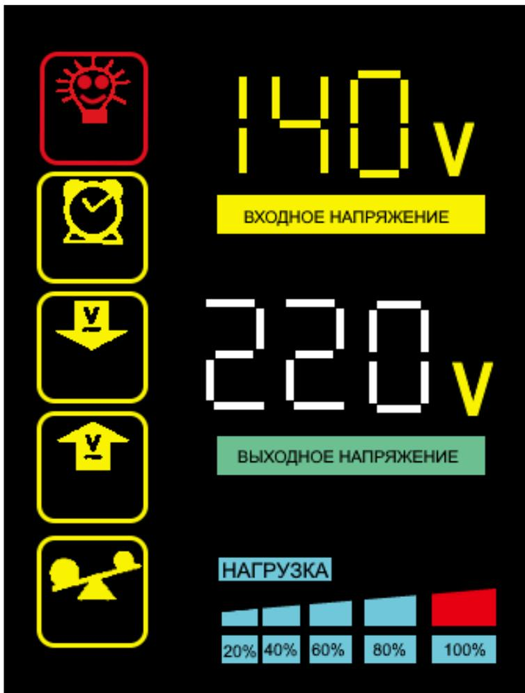
Индикатор мигает красным в следующих случаях: критически повышенное входное напряжение (более 250 В) или критически пониженное входное напряжение (менее 180 В),
