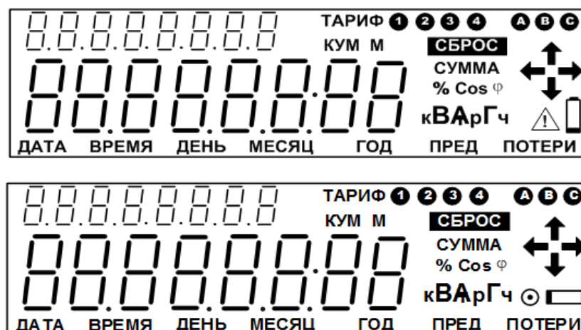
Рисунок 4.12 – Внешний вид ЖКИ
