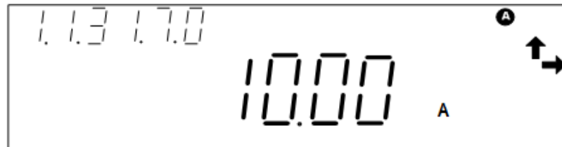
Рисунок 4.18 – Индикация действующего значения тока в каждой фазе
