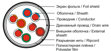
Рисунок 4 – Конструкция кабеля типа F/UTP (количество жил 4×2) / Figure 4 – Cable design of F/UTP type (number of cores 4×2)
