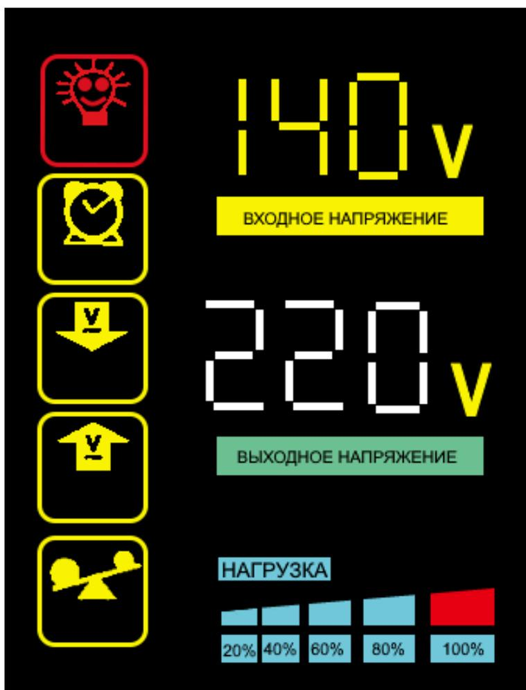
Индикатор мигает красным в следующих случаях: критически повышенное входное напряжение (более 250 В) или критически пониженное входное напряжение (менее 180 В),
